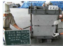
軸方向変位試験の状況 追随性を確認！はがれなし！
