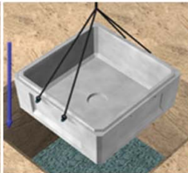
②吊金具をつけて本体下部B1部 材(底付)を4点吊りで据付します。
