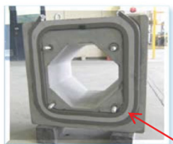
供試体の断面 （写真は注入工法） 高弾性接着剤 （TBボンド）
